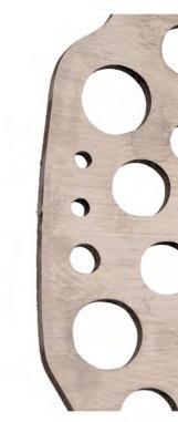
NON BEDDED DISC - GRIND MARKS VISIBLE
